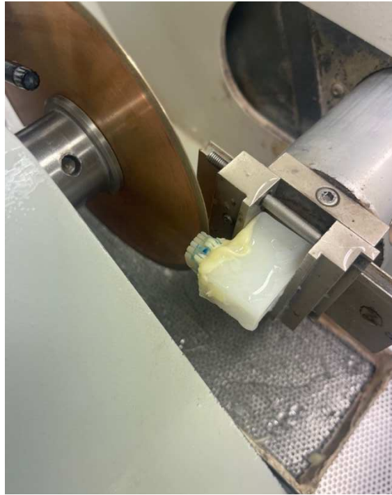
Figura 14. Representação do corte em palitos no micrótomo do complexo dente-restauração.
