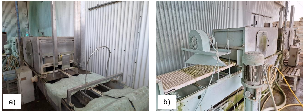
Figura 7 a) colocação dos tabuleiros no sistema de lavagem (Conic System® - LNB-200, 2014); b) lavagem dos tabuleiros. (Fonte: Próprio, 2024)
