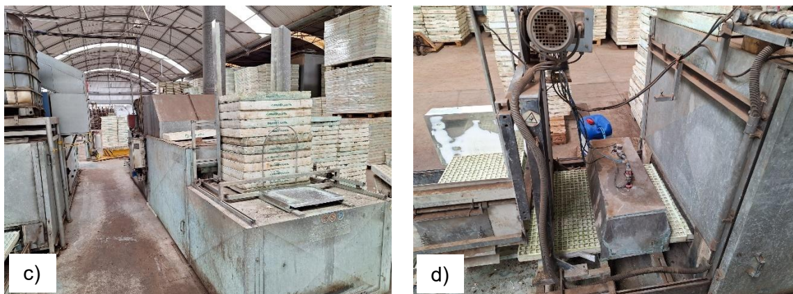
Figura 10 Passos do processo de secagem e desinfecção de tabuleiros. a) Entrada dos tabuleiros no primeiro forno; b) saída dos tabuleiros do primeiro forno; c) colocação e entrada dos tabuleiros no segundo forno; d) saída dos tabuleiros do segundo forno e aplicação de OXI PREMIUM® 15. Fonte: Próprio, (2025)
