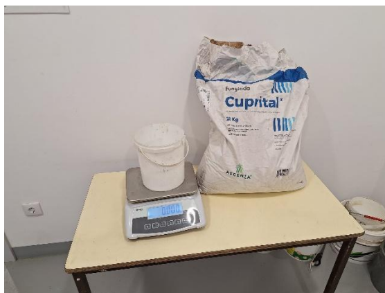
Figura 9 Pesagem de oxiclureto de cobre (Cuprital®) e Argalite incolor (Arga®), com utilização da balança Baxtran, modelo Bow-P, para a realização das soluções de cobre.
