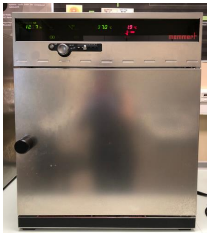
Figura 13. Estufa de laboratório UFE 400 (Mettmert® GmbH, Schwabach, Alemanha) a 37 °C de temperatura constante.
