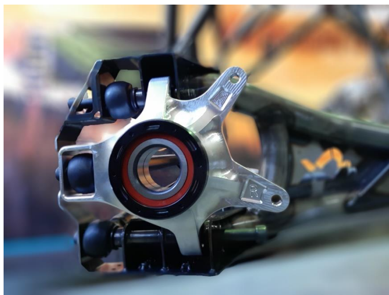
Figura 115- Manga eixo traseira Can-Am X3 totalmente projetada e maquinada na empresa Extra Motion
