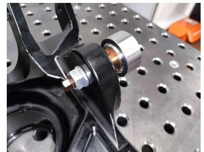
Figura 117- Conjunto peças torneadas para mangas eixo da frente
