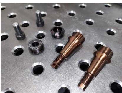
Figura 117- Conjunto peças torneadas para mangas eixo da frente
