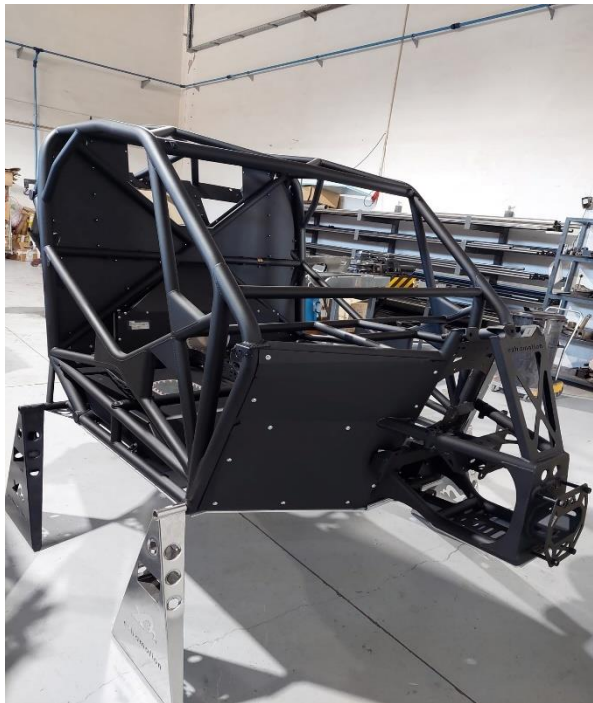
Figura 16- Chassi XDK produzido pela empresa Extra Motion
