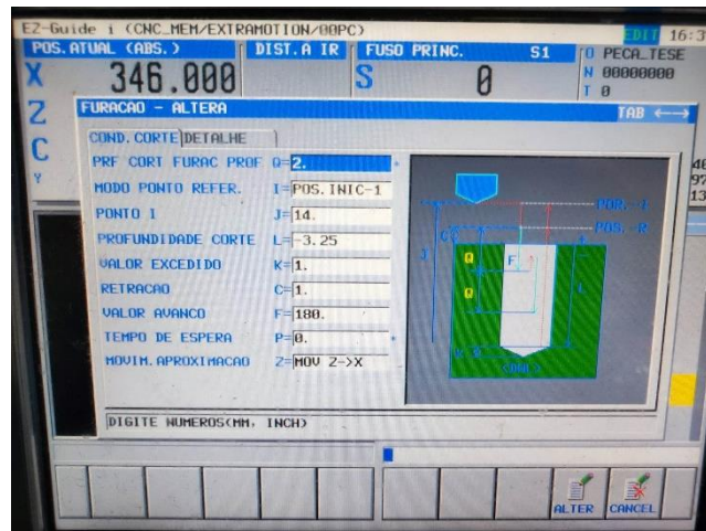
Figura 106- Indicação das condições de corte para uma operação de furação com ferramenta rotativa
