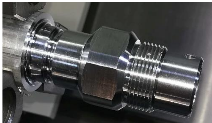
Figura 114- Peça Torneado num centro de torneamento CNC Doosan Lynx 2100 LYB
