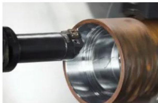
Figura 42- Torneamento longitudinal Interno (Sandvik C., 2019)
