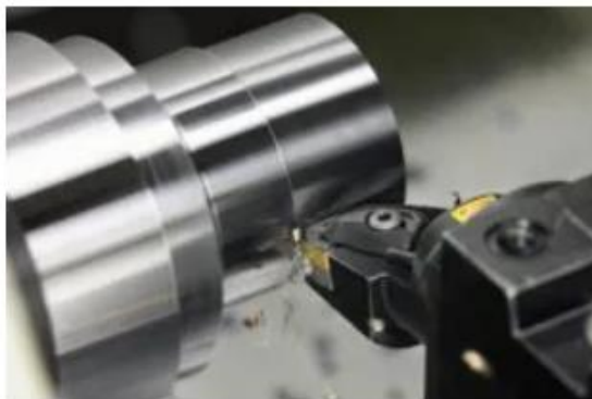
Figura 38- Torneamento longitudinal Externo (Sandvik C., 2019)
