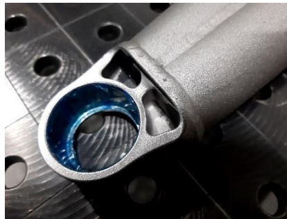
Figura 13- Exemplo de uma peça Fresada e já soldada ao braço de suspensão dos veículos Can-Am X3
