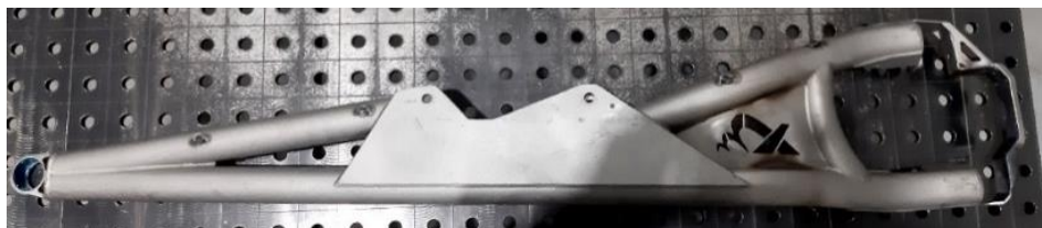
Figura 15- Braço suspensão do Chassi X-DK Produzido na Extra Motion que equipa os veículos Can-Am X3
