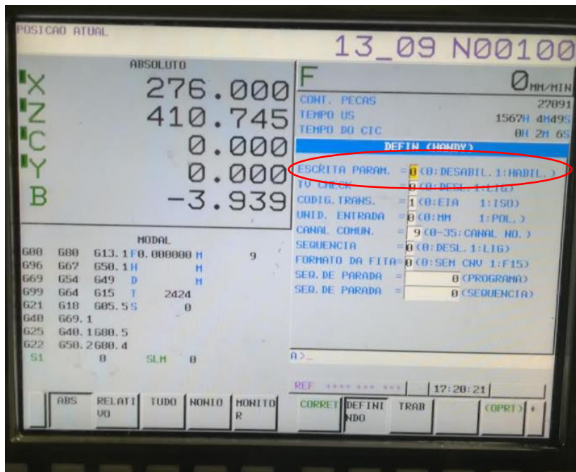
Figura 130- Sequência de Operações realizadas no controlador para resolução de erro (passo 8)
