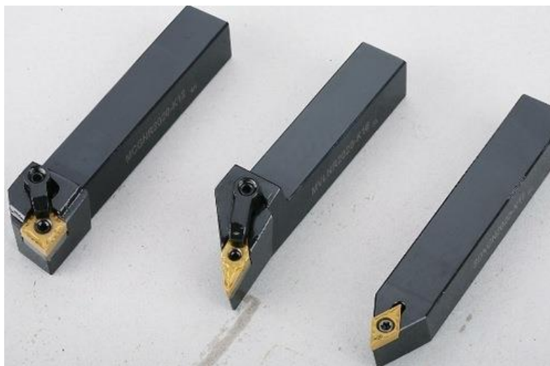
Figura 61- Representação de diferentes geometrias de porta-ferramentas
