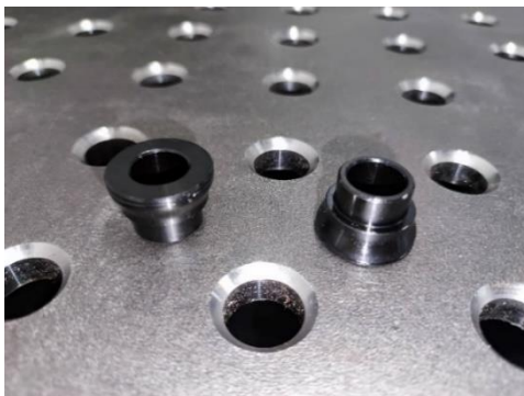
Figura 116- Conjunto peças torneadas para mangas eixo traseiras
