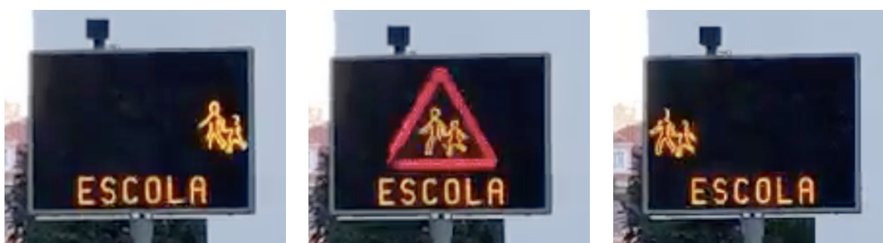
Figura 70 Exemplo de Sinalização com Movimento
