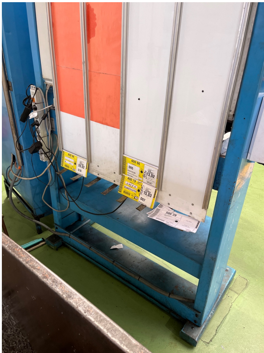
Figura 17 – Quadro kanban referente a placas interiores e exteriores para correntes de 12 velocidades.
