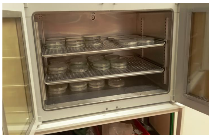
Figura 23-Estufa a 25°C para germinação das sementes.
