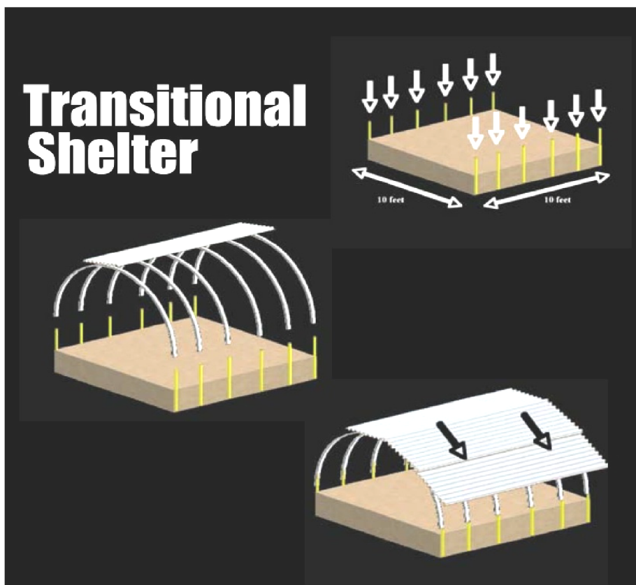
Fig. 120 - esquema de montagem do abrigo
