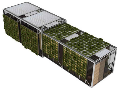
Fig. 58 - Exemplo de combinação de módulos - a Ecobitat prefab modular system (dois módulos acoplados)
