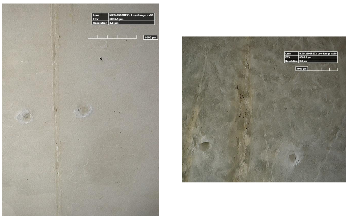
Figura 6. 2. F0-PRL-FEM-CM-76 (izquierda) y F2-PLL-AST-CM-103 (derecha). Puntos de referencia realizados con una aguja para digitalizar el mismo perfil tras cada fase.
