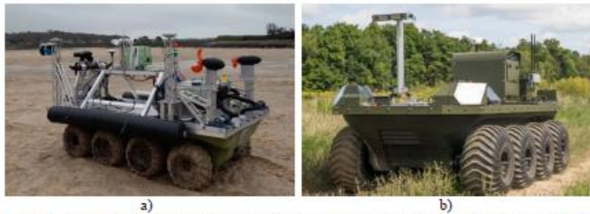
Figura 1 - Exemplo de Veículos Terrestres Anfíbios Não Tripulados: a) Argonaut da Ultrabeam Hydrographic; b) Moose da Clearpath Robotics
