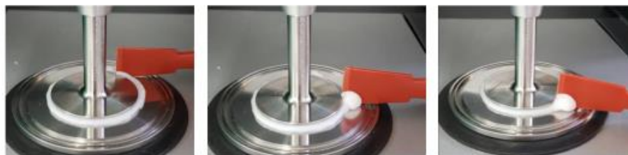
Figura 3.6 – Remoção do excesso de amostra existente.
