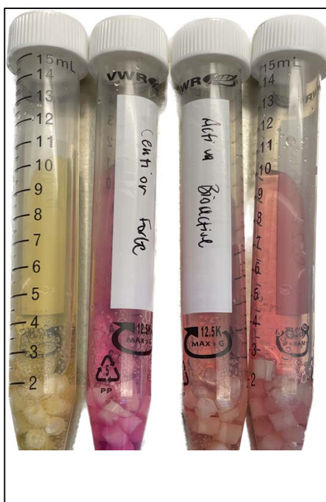
Figura 5. Fotografia dos 16 cilindros em 4ml de DMEM. De esquerda para direita, Photac, Cention Forte, Activa Bioactive, Filtek Z250.
