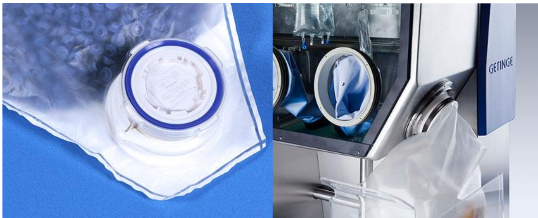
Figura 12 - DPTE Beta-Bag com vista aproximada da porção beta, e à direita DPTE Beta-Bag acoplado ao isolador barreira (GETINGE, 2010b)
