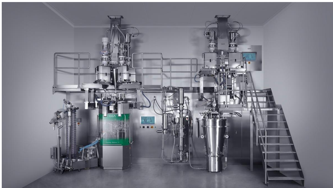
Figura 16 - Sistema ConsiGma™ de produção contínua (GEA, 2015d)
