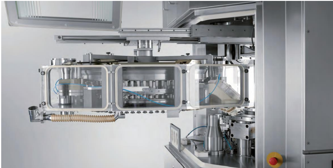
Figura 15 - Módulo de compressão incorporado com sistema WOL, desacoplado da máquina de compressão (GEA, 2015e)
