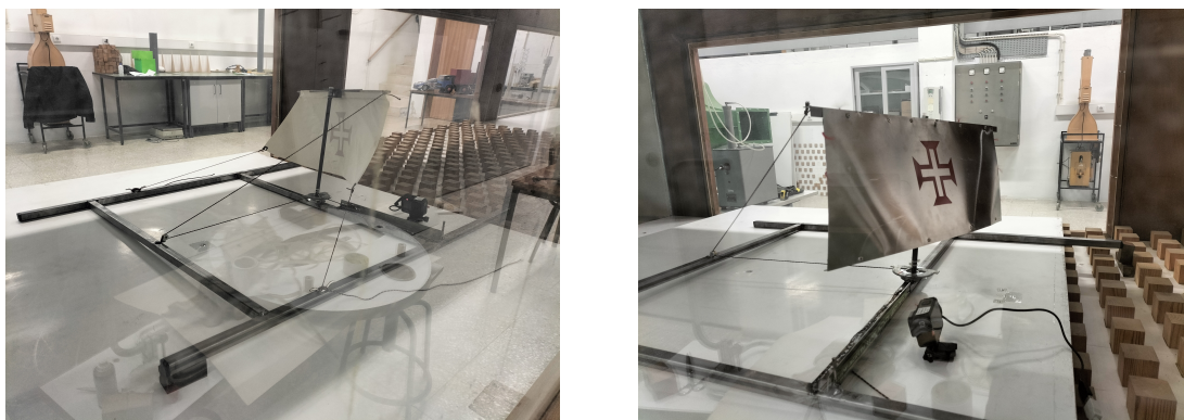
FIGURA 3.21: Imagens exemplificativas de diferentes modelos de velas durante os ensaios no túnel aerodinâmico
