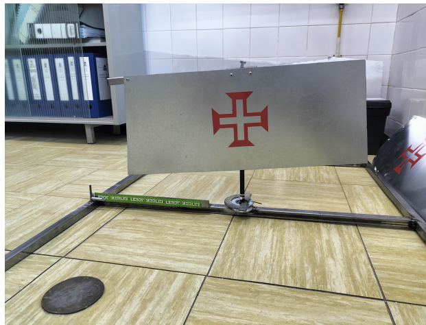
FIGURA H.1: Modelo de uma vela rígida bidimensional numa vista frontal.
