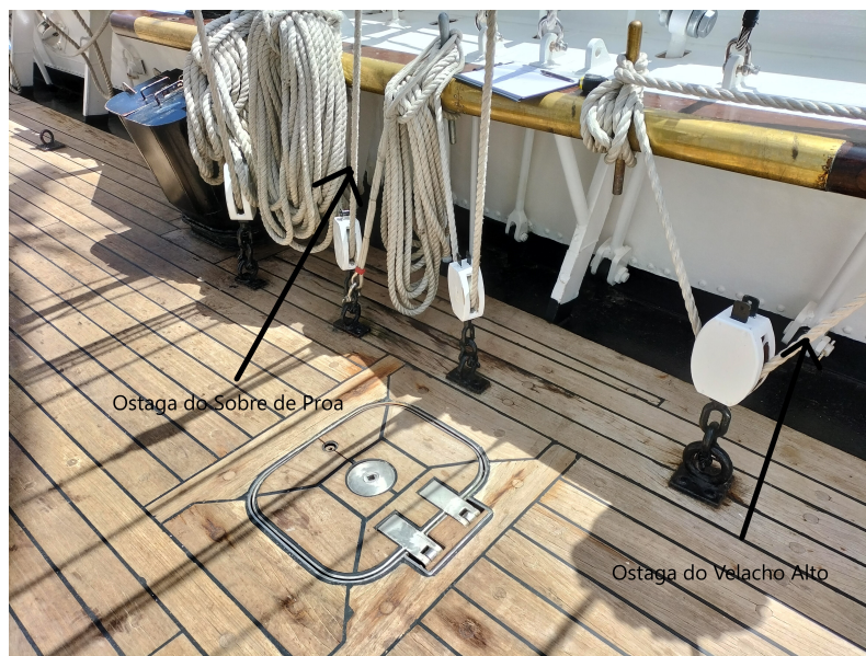
FIGURA 4.3: Localização e características da ostaga do velacho alto e do sobre de proa (B1).
