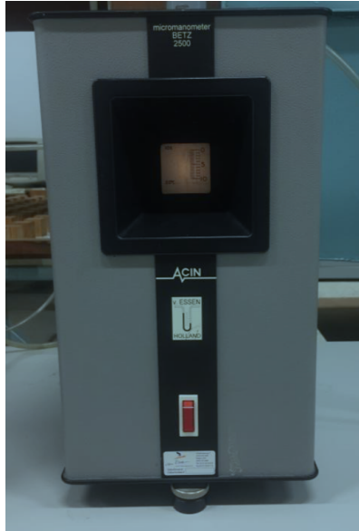
FIGURA 2.15: Fotografia do manómetro de Betz utilizado nas medições (de Carvalho, 1997).
