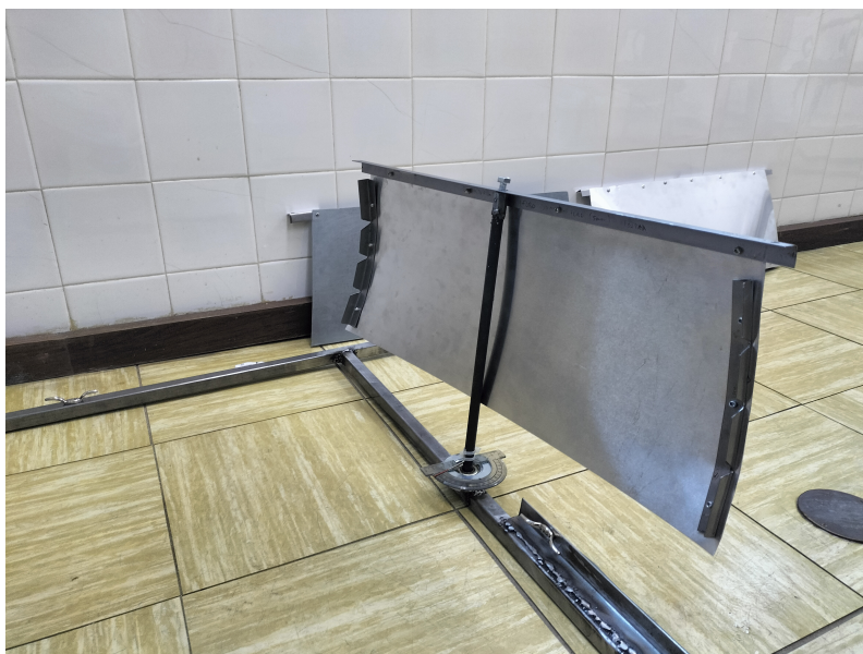
FIGURA H.4: Modelo de uma vela rígida tridimensional (curvatura no eixo horizontal) numa vista posterior.
