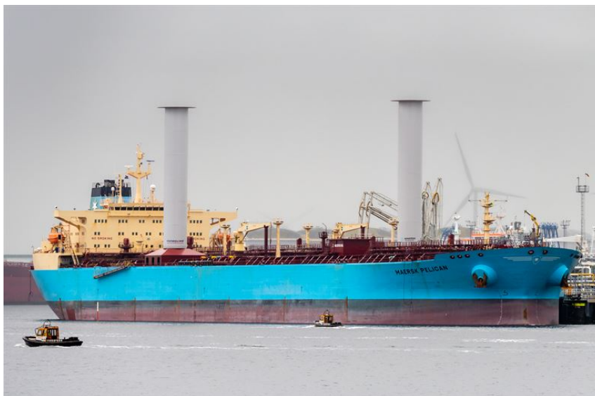
FIGURA 2.5: Navio da marinha mercante com instalação de rotor sails (Norepower, s.d.).
