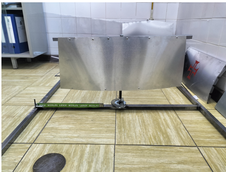
FIGURA H.5: Modelo de uma vela rígida tridimensional (curvatura no eixo Vertical) numa vista frontal.
