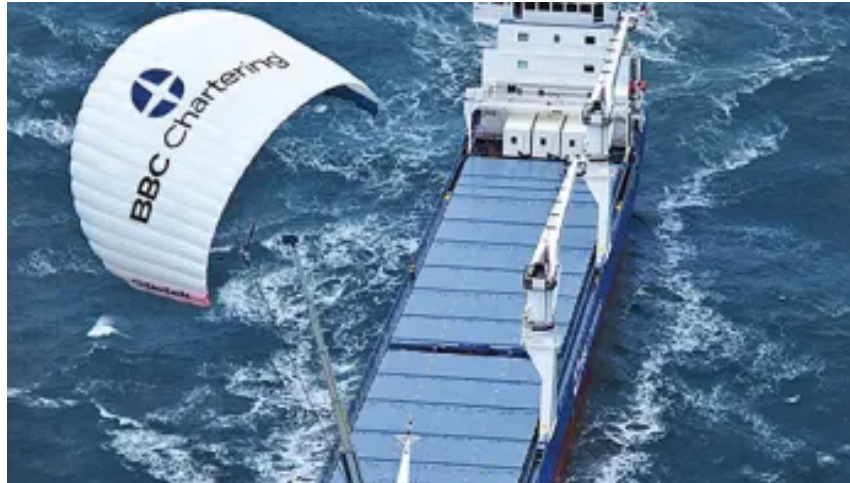
FIGURA 2.4: C 320 Kite um modo pioneiro nos métodos de propulsão assistidos por vento (SkySails Marine, s.d.).
