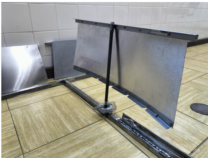
FIGURA H.6: Modelo de uma vela rígida tridimensional (curvatura no eixo Vertical) numa vista posterior.
