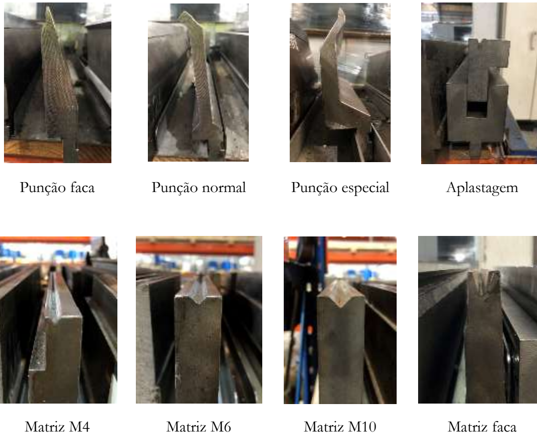
Figura 4.6 - Tipos de ferramentas nas quinadoras
