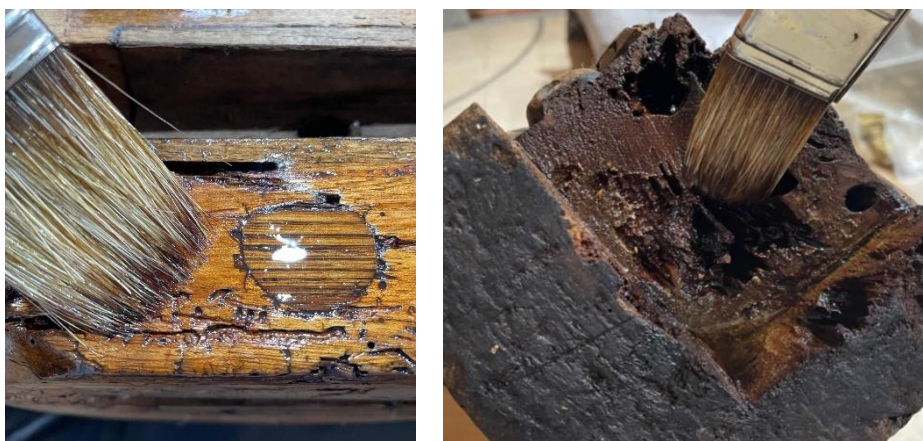
Fig.98 Consolidação das duas pernas direitas com Paraloid B72 + Xileno a 6%. © Juliana Novaes.
