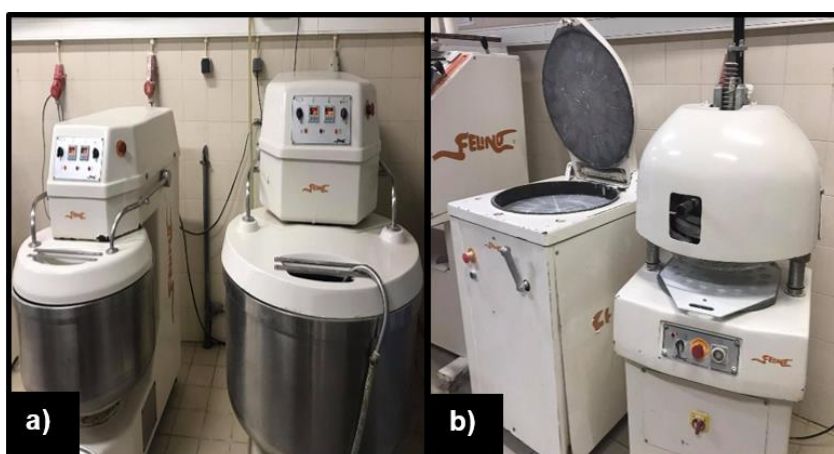
Figura 7 - Equipamentos higienizados da secção Padaria: a) Amassadeiras; b) Divisoras de massa.
