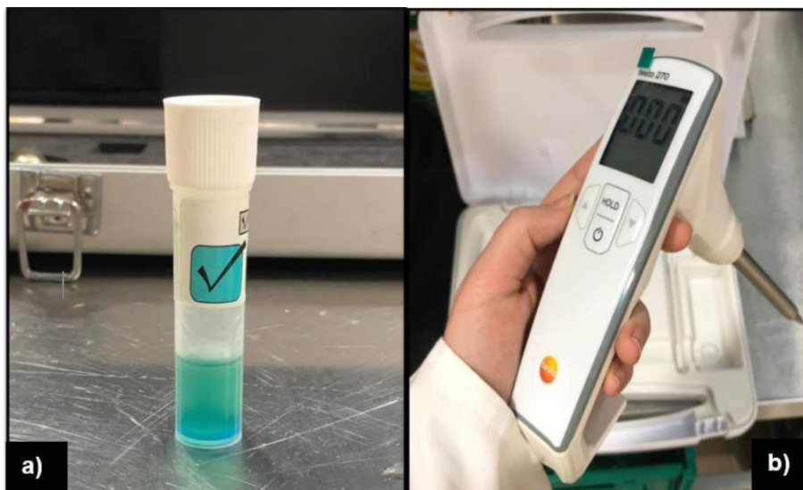
Figura 12 - Testes da qualidade do óleo: a) Teste rápido; b) Termómetro para medição de temperatura.
