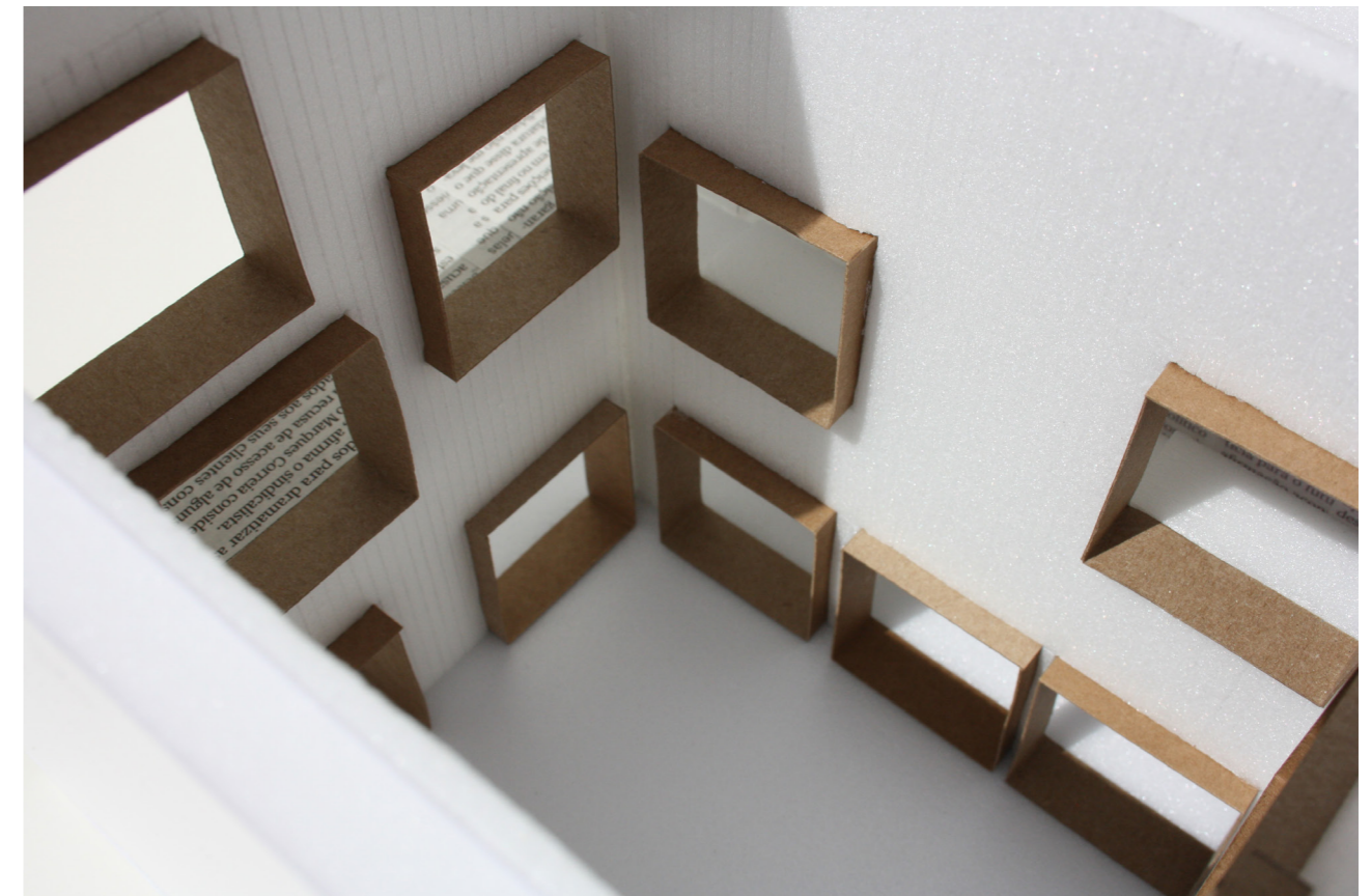
077 A 079 | Maqueta de estudo do pátio. Relação da preexistência com a introdução do elemento em betão e respetivos vãos. Estudo realizado à escala 1:50
