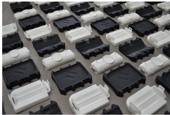
Figura 13 - Exemplo de produção em pequena série pela empresa 3DPrintUK (Fonte: https://www.3dprint-uk.co.uk/3d-printed-low-volume-batch-production-runs/ )
