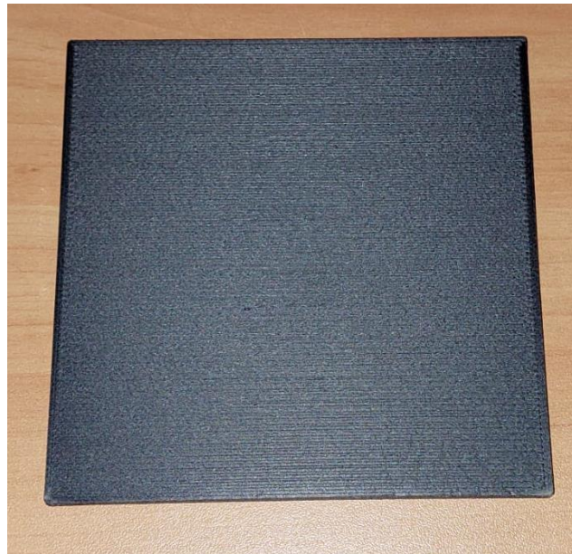
Figura 17 - Provete de Impacto Carbon-P
