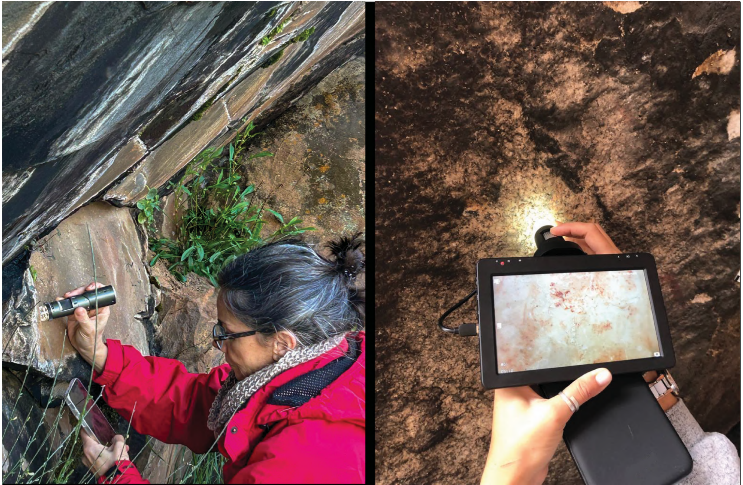
Fig. 2 – Para uma análise mais profunda do estado de conservação dos elementos pétreos e das camadas pictóricas, assim como dos produtos de alteração que se vão sobrepondo às superfícies é fundamental recorrer a equipamentos de exame mais minuciosos, como lupas e microscópicos digitais. Estes aparelhos tornam-se imprescindíveis para os trabalhos de campo, podendo observar-se com mais clareza, até as matérias que se pretendem recolher para análise laboratorial.
