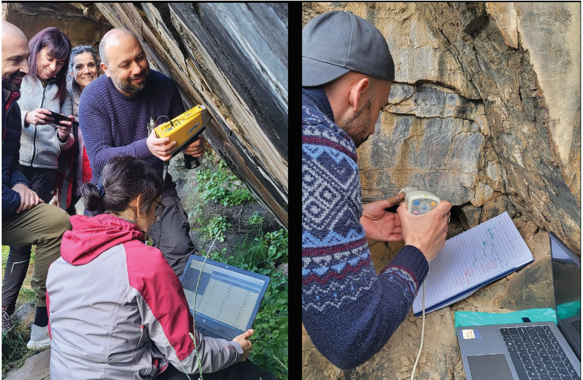
Fig. 6 – Exames realizados em in situ pela Universidade de Vigo em colaboração com o Incipit-CSIC - Consejo Superior de Investigaciones Científicas. À esquerda: espectrometria de fluorescência de raios X (FRX) no painel 2 do abrigo do Poço Torto, realizado por Lucía Pereira e Lois Armada, com Santiago Pozo-Antonio, Lara Bacelar Alves e Teresa Rivas Brea; à direita: espectrofotometria da cor no painel 3 da rocha 60 de Ribeira de Piscos, realizado por Santiago Pozo-Antonio.
