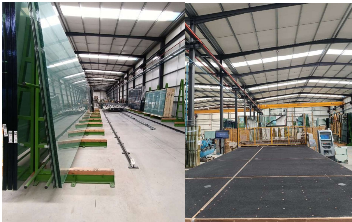
Figura 2. Armazenamento de chapas e mesa de corte
