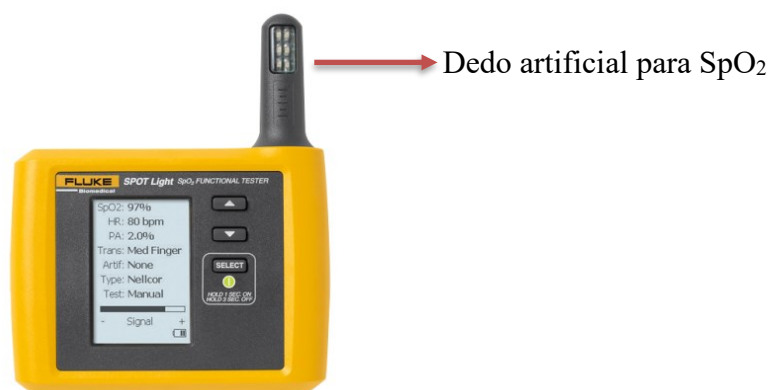
Figura 9: Equipamento de Teste Simulador de Sinais Vitais - ProSim SPOT Light SpO2 da Fluke Biomedical 6 .
