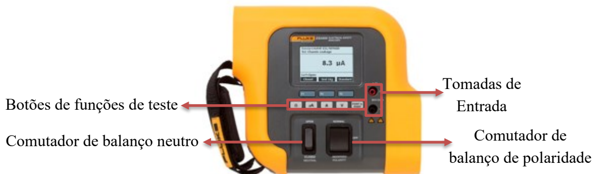
Figura 5: Equipamento de Teste de Segurança Elétrica - ESA609 da Fluke Biomedical 2 .
