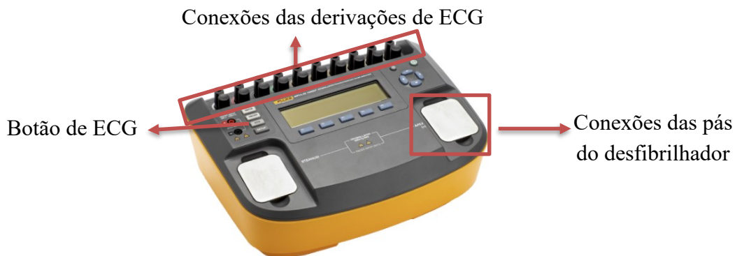
Figura 6: Equipamento de Teste Analisador de Desfibrilhadores - 7000DP da Fluke Biomedical 3 .
