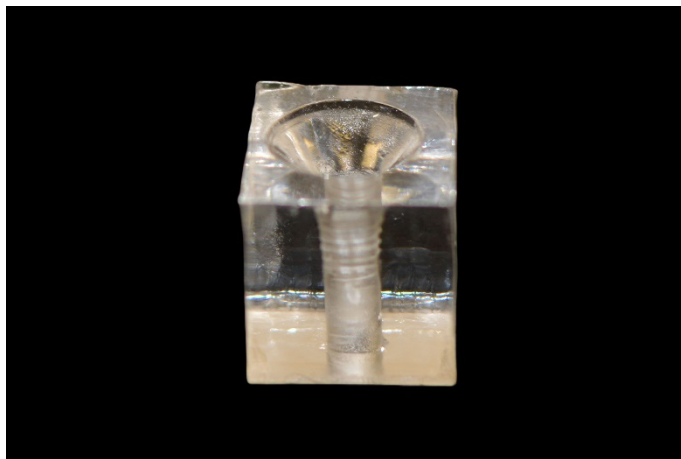
Figura 4: Modelo de acrílico de um alvéolo onde foram imobilizados os implantes.
