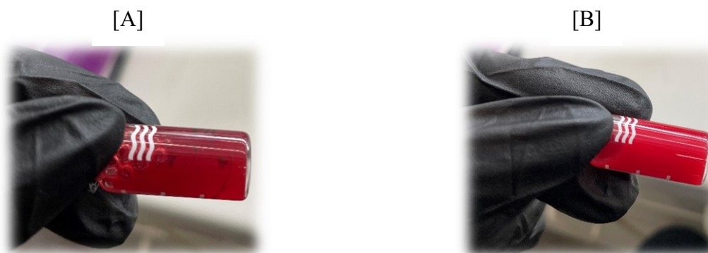
Figura 27. Solução amostra precipitada devido ao excesso de sal [A]; Solução amostra sem precipitado, após reduzida a quantidade de sal [B].
