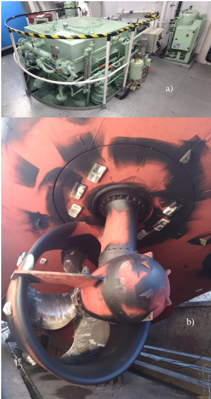
Figura 4-5 – Um dos Propulsores: a) Caixa do propulsor na casa do leme; b) Propulsor submerso
