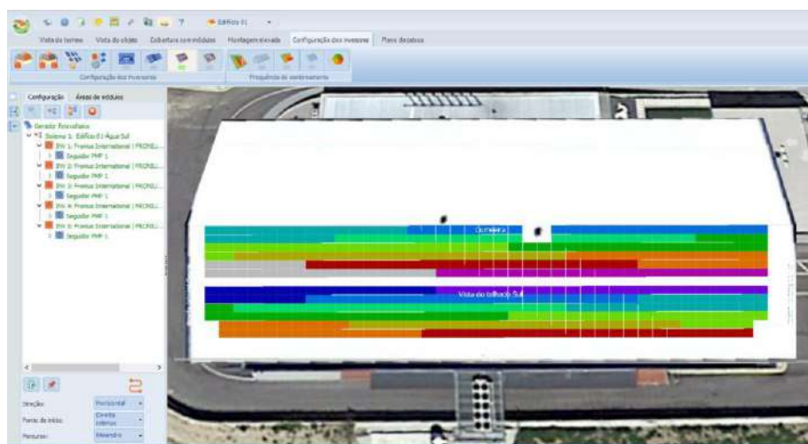
Figura 5.133 - Distribuição das string's para cada inversor, (PvSol).
