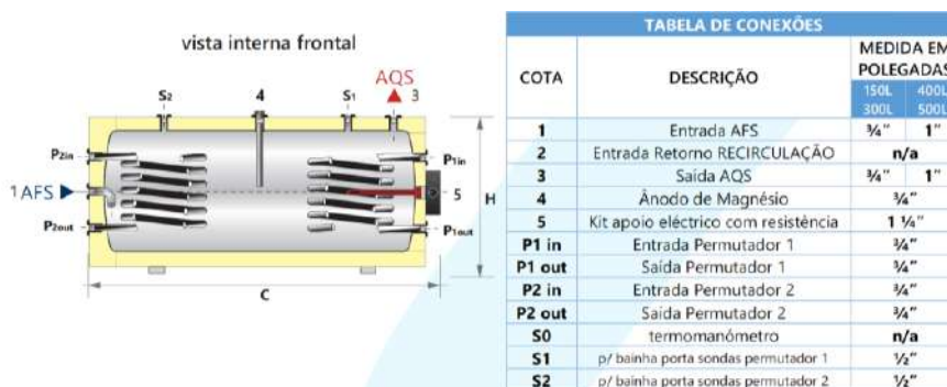
Figura 4.21 - Termoacumulador horizontal com 2 permutadores, (AQUAFER, 2018).
