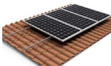
Figura 5.12 - Estrutura com varão roscado e perfil corrido, cobertura de telha lusa.
