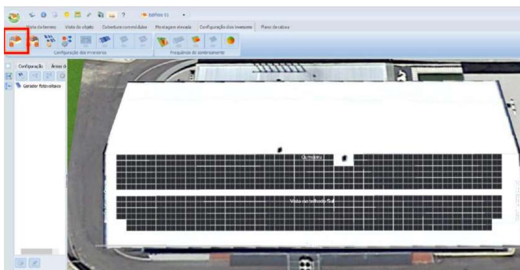
Figura 5.130 - Dimensionamento de Inversores, (PvSol).
