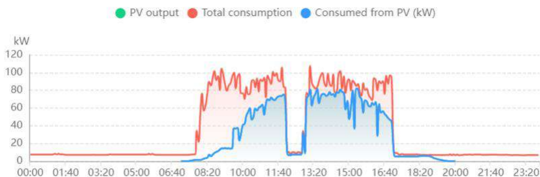
Figura 5.91 - Gráfico de Consumo vs Produção Fotovoltaica com controlo de injeção, através da plataforma FusionSolar.
