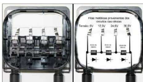
Figura 5.44 - Caixa de junção de 3 díodos "bypass" e conexões, (CRESESB, CEPTEL, 2014).
