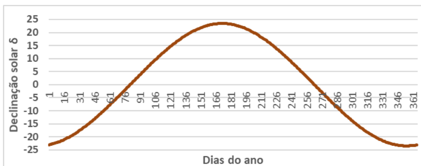
Figura 3.19 - Variação do ângulo de declinação solar, calculada através da equação 3.1.
