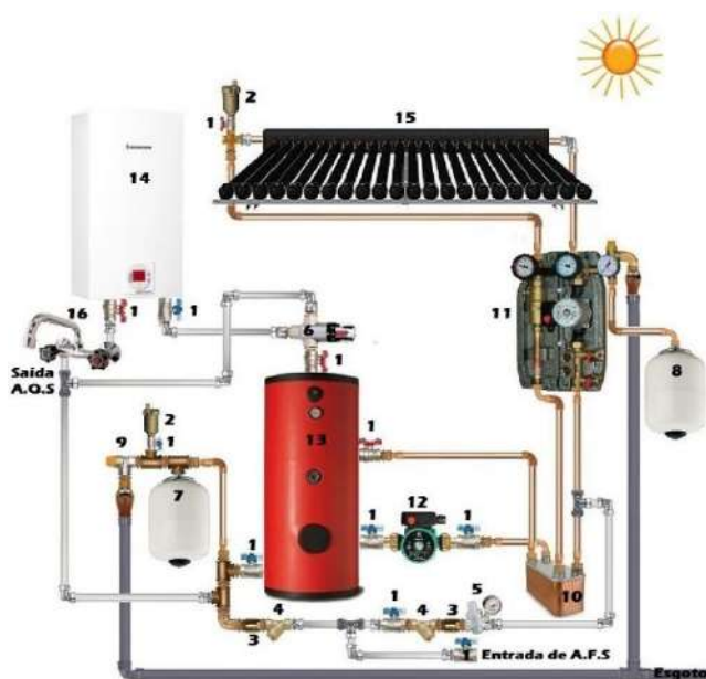
Figura 4.34 - Esquema de funcionamento hidráulico e elétrico de sistema solar de circulação forçada para AQS, (Jorge Silva, 2012).
