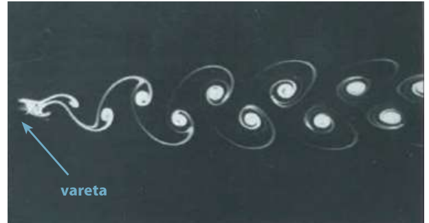
Figura 1. Estrada de vórtices de Kármán gerados por uma vareta cilíndrica introduzida num escoamento com R_e=140 . Crédito: Van Dyke, 1982.
