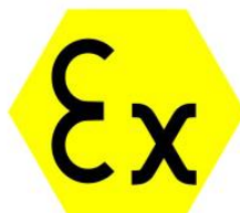
Figura 18 - Marcação ATEX (Fonte: http://pt.rs-online.com/web )
