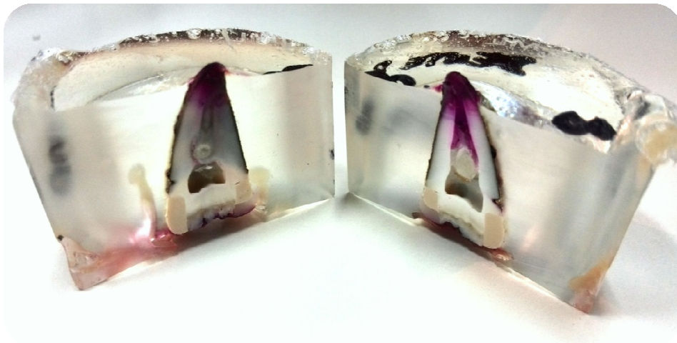
Fig. 10- Inclusão do espécime em resina Epoxy e corte.
