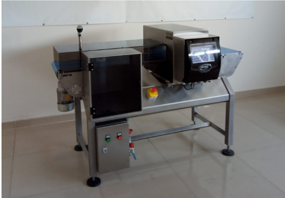
Figura 3.25: Detetor de metais com transportador
