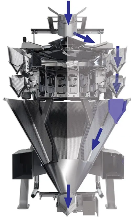
Figura 2.1: Princípio de funcionamento de uma multi-cabeçal [6]
