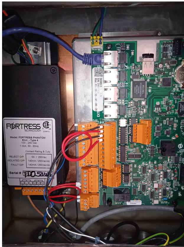
Figura 3.27: Ligações internas do detetor de metais
