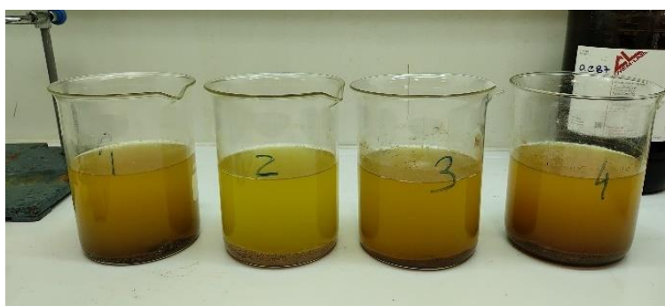
Figura 4.26 – Determinação do resíduo insolúvel: soluções ácidas com o material após repouso
