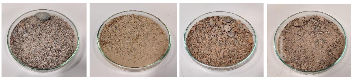
Figura 4.29 – Resíduo insolúvel das amostras para determinação da granulometria: (a) RTS 1.2; (b) J/C/1.1; (c) J/I/3.2; (d) EJMS 1.1 [Fonte – Autor]
