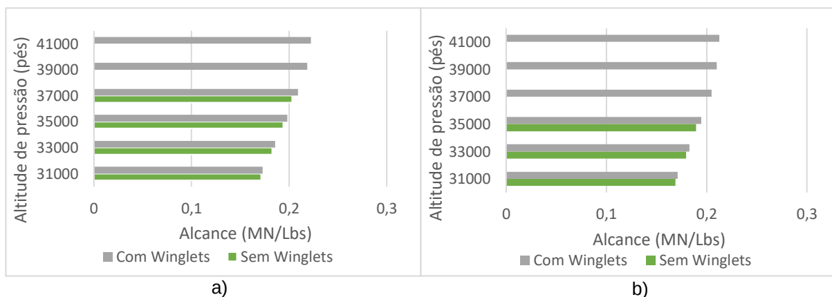
Figura E-2 Representação do alcance em milhas náuticas por libra, em função do nível de voo, à velocidade de 0.80M nas configurações: a) Low Feeder ; b) High Feeder
