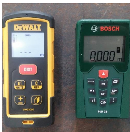
Figura 4-1 Medidores laser utilizados para medição da asa da aeronave
