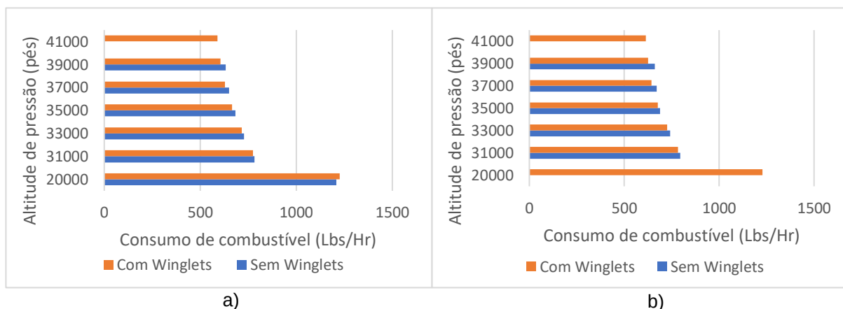
Figura C-2 a) Representação do consumo de combustível por hora da aeronave Falcon 50 com e sem winglets, em voo cruzeiro, na configuração Low Feeder; b) Representação do consumo de combustível por hora da aeronave Falcon 50 com e sem winglets, em voo cruzeiro, na configuração High Feeder
