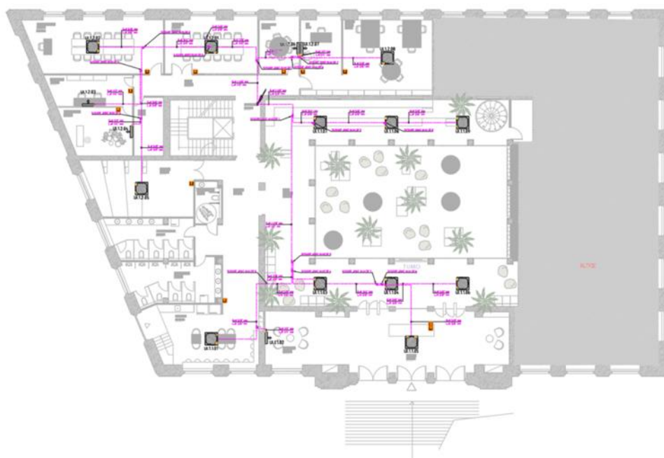
Figura 3.7 - Rede de fluido frigorígeno do piso 1
