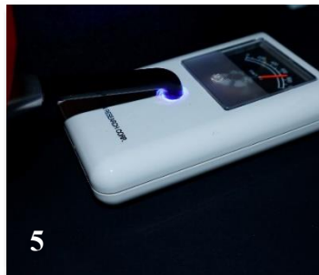
Figura 13 – Medição da intensidade LED com o radiômetro
