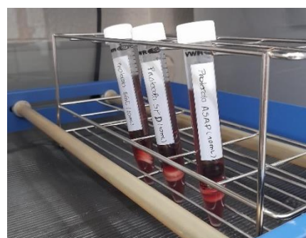
Figura 53 – Amostras submersas em vinho tinto na estufa
