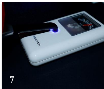
Figura 15 – Medição da intensidade LED com o radiômetro
