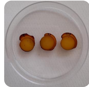
Figura 80 – Amostras sujeitas ao protocolo ASAP após imersão em vinho
