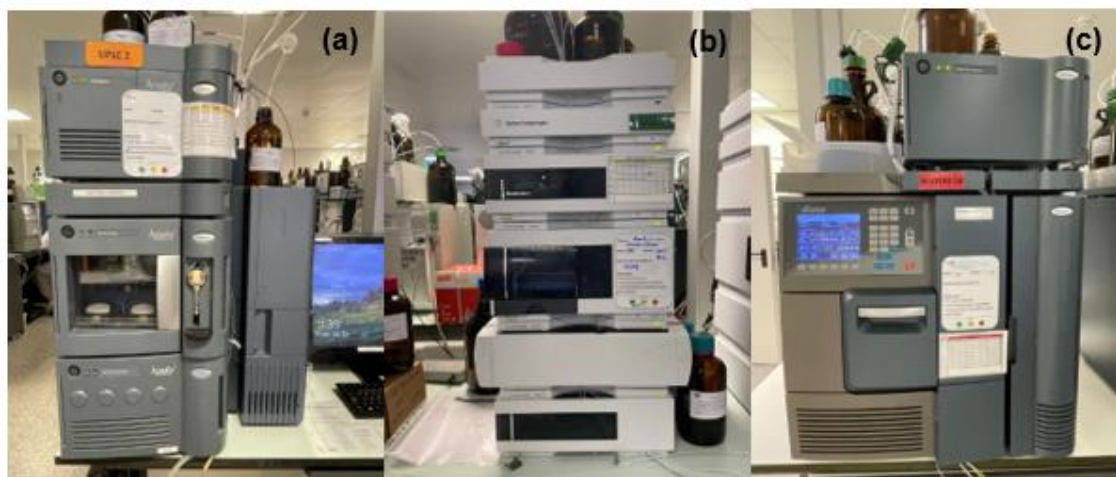
Figura 14- (a) Equipamento UPLC Class H, (b) Equipamento Agilent e (c) Equipamento Waters e2695, respetivamente, equipamentos HPLC usados no presente estágio.
