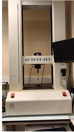
Figura 6 - Máquina de testes universal (Shimadzu Autograph AG-IS)
