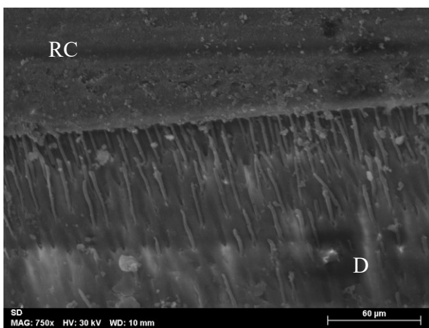
Figura 14- Interface adesiva criada no SD2, ampliação, 750x (RC- Resina composta, D-Dentina )
