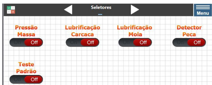
Figura 81 - Seletores de pressão, lubrificação de carcaça, mola, detetor da peça, e teste padrão (SPMAQ, 2021)
