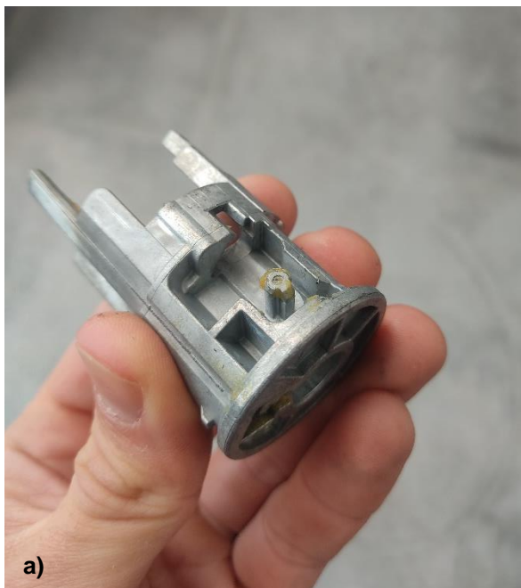
Figura 37 – O caso de estudo, a) Peça com a mola por colocar e b) A mola em questão
