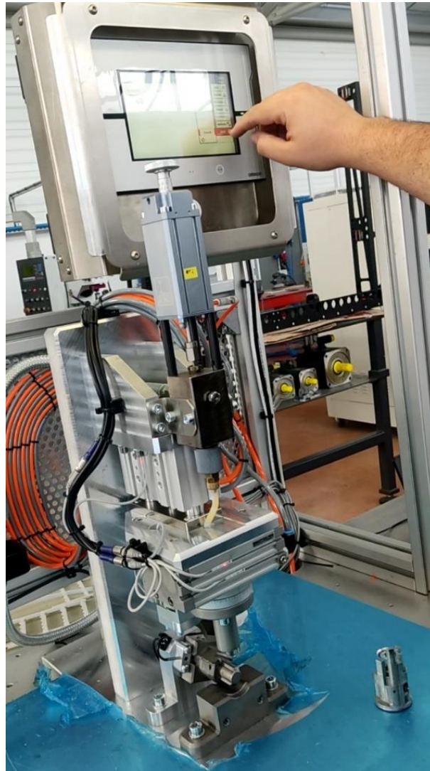
Figura 129 – Controlo da HMI
