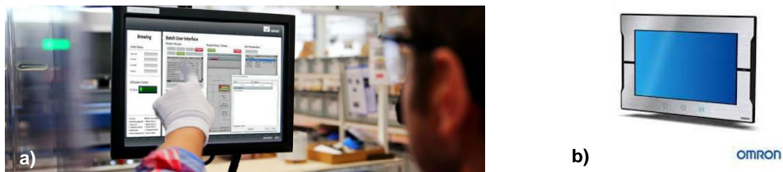
Figura 30 – a) Interação HMI por painel tátil e b) exemplo de HMI tátil da marca OMRON (OMRON, 2021)
