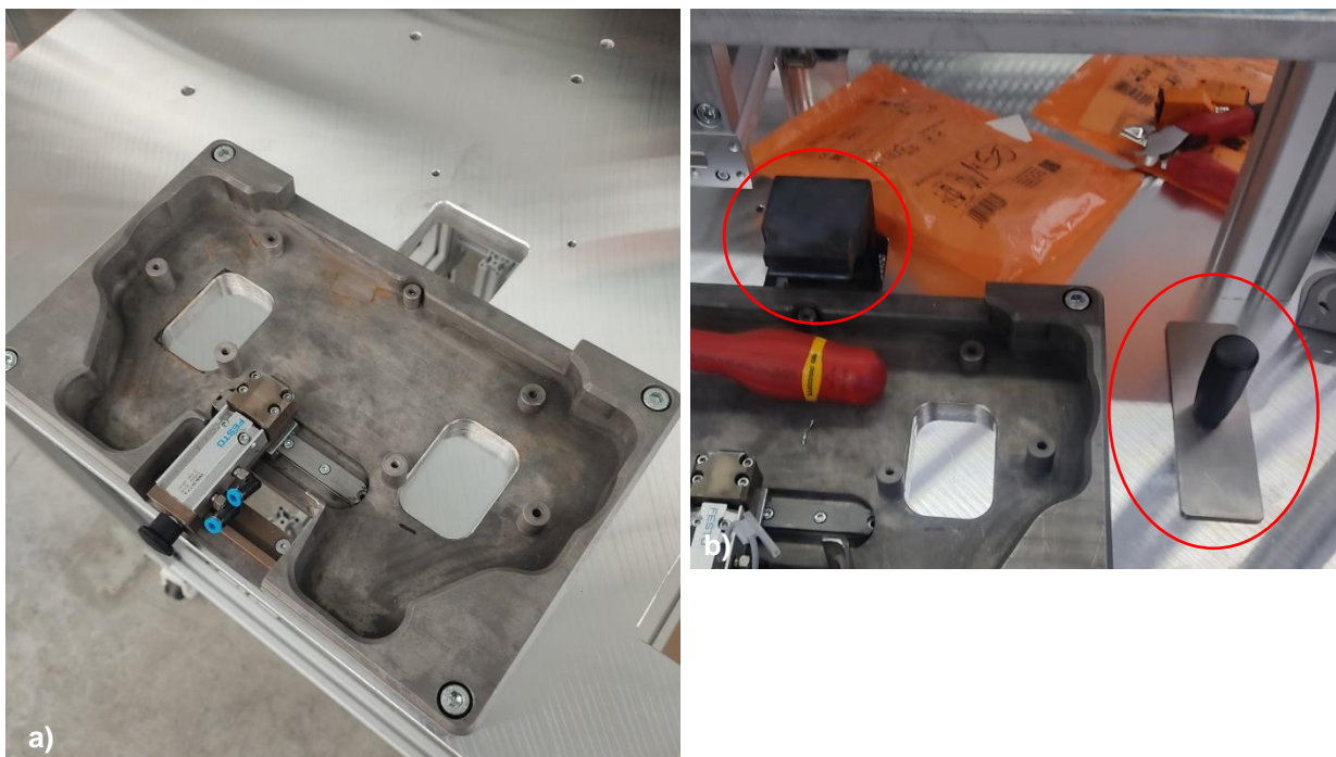
Figura 11 – a) Patamar inferior, e sistema pneumático de trancamento
