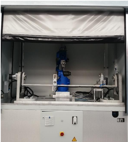
Figura 27 - Gabarito Rotativo para análise dimensional por câmara-robot (SPMAQ, 2021)
