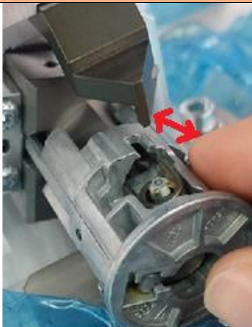
Figura 91 - Detalhe do risco apresentado, dedo extremamente perto do calcador
