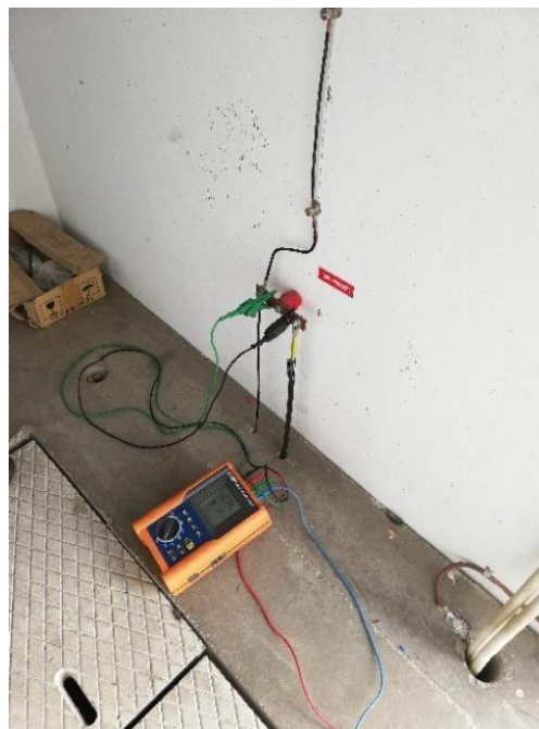
Figura 4.301-Medição da terra de serviço
