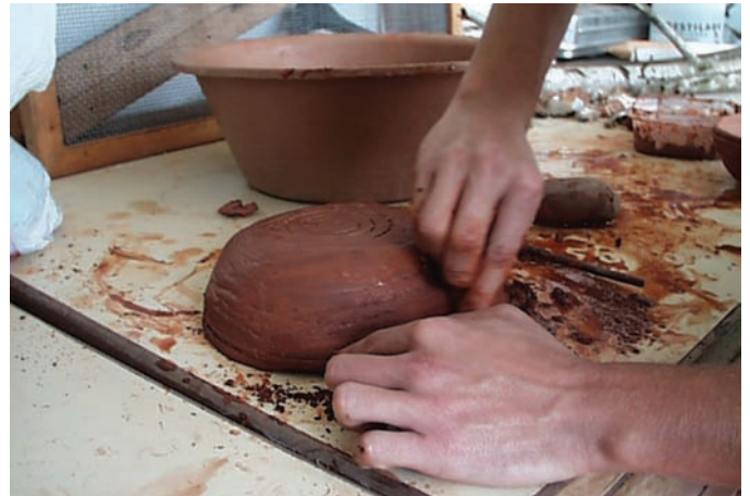
fig. 4 Elaboração de uma taça hemisférica segundo a técnica dos rolos sobrepostos.
