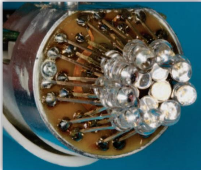
Figura 12 - Exemplo da configuração interna de um LED de 1ª Geração (Adaptado de Ritter et al., 2018).
