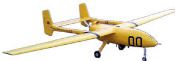
Figura 1.2: O UAV considerado nesta dissertação de mestrado, o ANTEX - X02 Alfa Extended.
