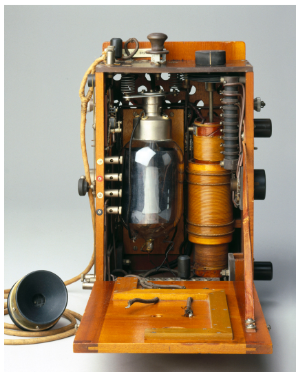
Figura 1.1: Dispositivo que permitia comunicações ar-solo durante a 1 a Guerra Mundial.
