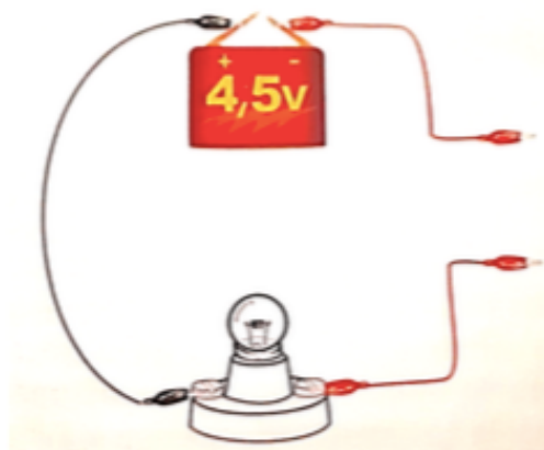
Fig. 2- Circuito elétrico aberto
