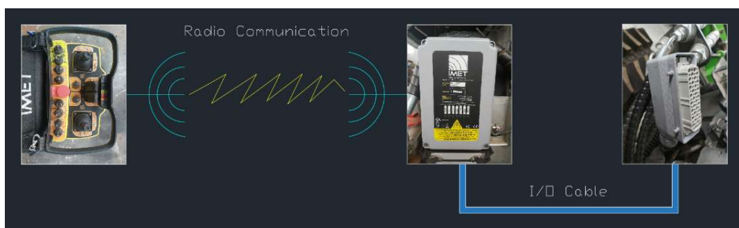
Figura 42 – Método de operação da máquina utilizando o controlo remoto
