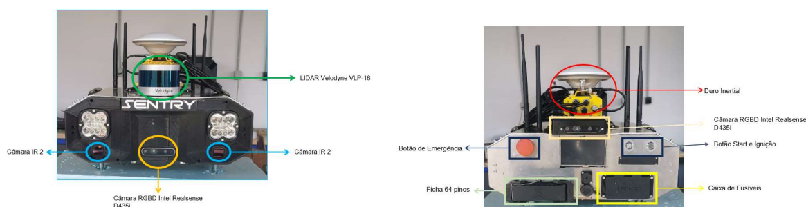
Figura 48 – Demonstração de todos os sensores montados no Sentry
