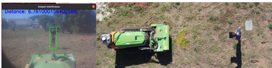
Figura 118 – Procedimento de uma das etapas do teste do Algoritmo do sistema de visão no terreno. Neste caso a pessoa situava-se a 6 metros da câmara frontal do Sentry
