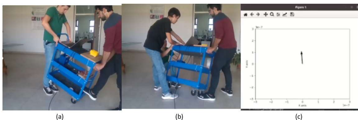
Figura 106 – Resultado da experiência do tilt no laboratório. (a): Movimento executado no eixo X ; (b): Movimento executado no eixo Y ; (c): Seta designada como a direção dada pelo Heading
