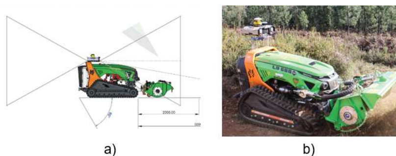
Figura 41 – Integração Mecânica do Sentry na LV 600 PRO: (a) Verificação dos Campos de Visão das Câmaras; (b) Validação da Estrutura Mecânica na LV 600 PRO
