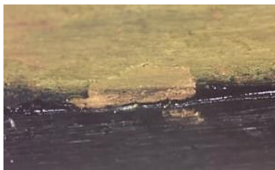
Figura 22 - Pormenor de falha da camada alaranjada, com sobreposição de tinta. MD 50×
