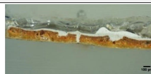
Corte estratigráfico Microscópio ótico -40X
