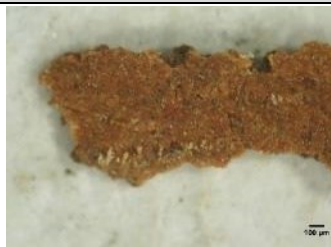
Verso da amostra Microscópio ótico -40X
