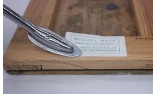
Figura 51 - Ativação do adesivo com espátula quente
