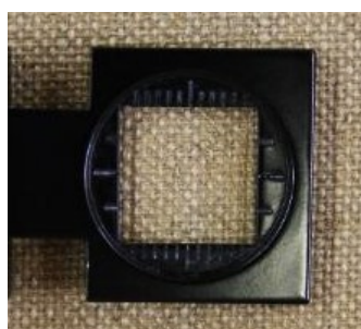
Figura 26 - Medição da densidade da tela da pintura Red and Rose
