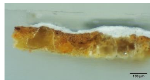
Corte estratigráfico Microscópio ótico -100X
