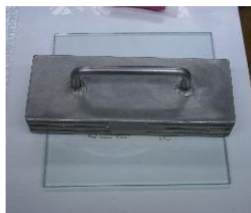
Figura 66 – Documento sob peso para planificação
