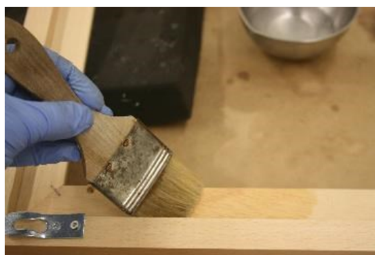
Figura 73 - Imunização de uma das molduras
