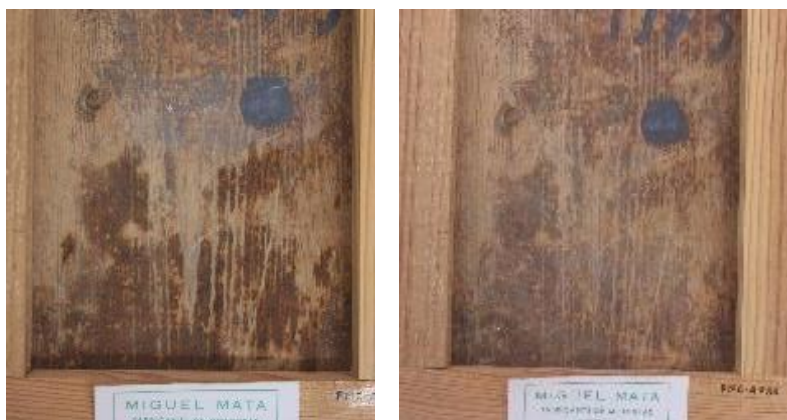
Figura 49 - Efeito no momento da aplicação do adesivo (à esquerda) e após secagem do adesivo (à direita)
