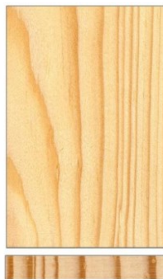
Figura 149 – Corte tangencial e transversal de uma madeira de pinho-bravo. Fonte: AIMMP, 2015, p. 169
