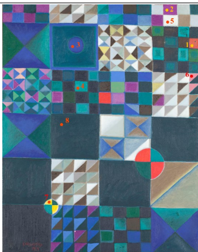
Figura 131 - Mapa de pontos indicativos das cores da pintura Murfacem , medidos por colorimetria.
