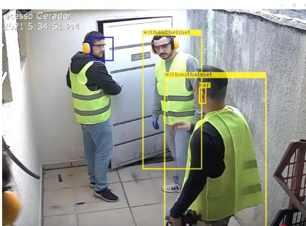
Figura 7 – IPXAnalytics Módulo Industrial (Detecção de EPI)
