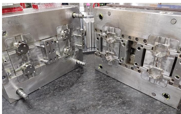
Figura 9 – Molde aberto e componentes (Fonte: Autor, 2024)
