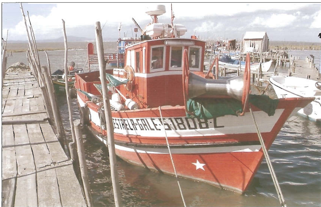
Fotografia 8 - Embarcação cabinada com motor fixo.
