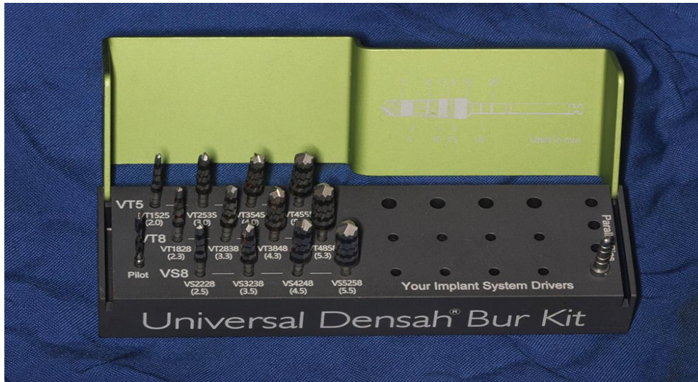
Figura 18 - Kit Versah com brocas de densificação. Adaptado de: (Pai et al., 2018).
