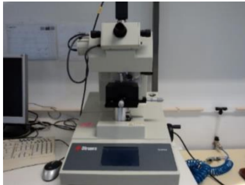
Figura 12 – Máquina de teste de microdureza de Knoop (Duramin, Struers, A/S, DK 2750, Ballerup, Denmark)
