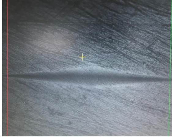
Figura 14 – Ensaio de microdureza de Knoop visto num microscópico ótico
