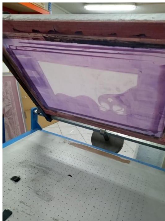
Figura 24. Imagem da esquerda: Impressão manual do projeto pessoal de serigrafia. Imagem da direita: Máquina manual de serigrafia.
